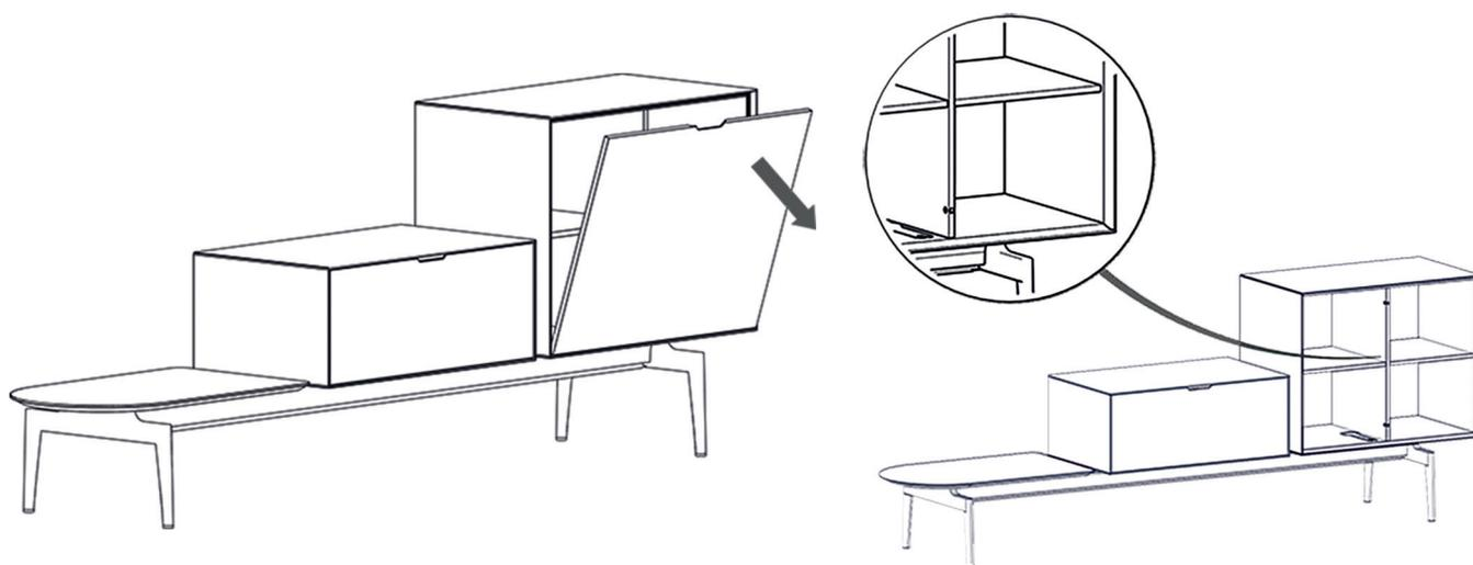
Un passa cavo presente sul fondo del contenitore permette di raggiungere il vano tecnico presente nella trave. Una cover in tinta con la scocca e che presenta uno scanco per far passare il cavo, consente poi di coprire il foro.
