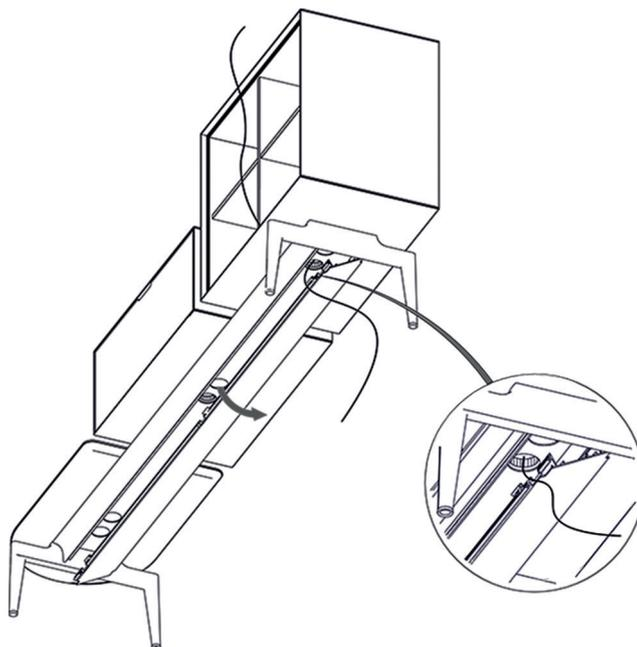
Quando viene rimessa in posizione la schiena del contenitore, al fine di nascondere il cavo, quest'ultimo viene fatto passare all'interno dello scanco ricavato nella parte superiore della schiena stessa, garantendo così una pulizia d'insieme.
