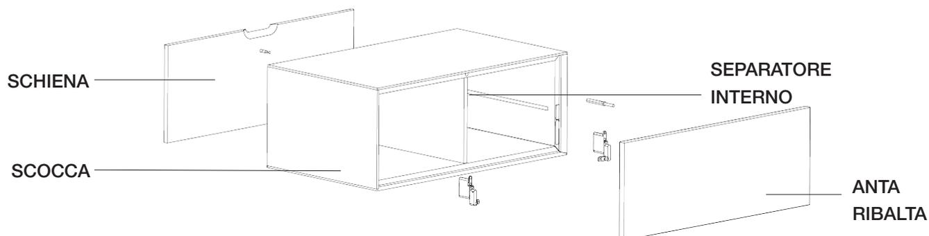
Il modulo contenitore H. 60 cm è disponibile in tre versioni: passante, a giorno o dotato di ante battenti. Ogni modulo presenta un separatore interno centrale e un ripiano orizzontale. La posizione del ripiano orizzontale è configurabile a due livelli (centrale o a 2/3 verso l'alto). La scelta fra le due opzioni è da definibile in fase d'ordine e non modificabile in una fase successiva.
